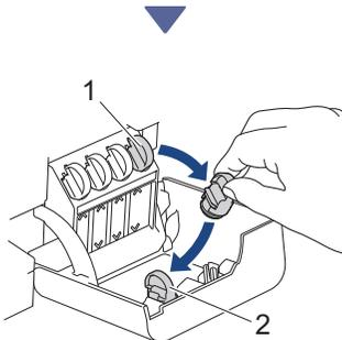
Remova a tampa (1) e coloque-a na parte traseira do compartimento (2).
