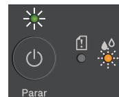
Quando o LED de energia elétrica piscar lentamente, mantenha o botão **Cópia Preto** pressionado por três segundos.
