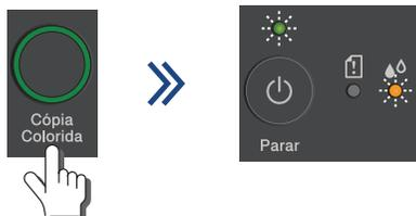
Mantenha o botão **Cópia Colorida** pressionado por três segundos para começar a limpeza inicial do sistema de tinta. Durante a limpeza inicial, os LEDs de energia elétrica e de tinta piscarão. A limpeza pode levar alguns minutos.
