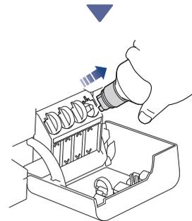
Quando acabar, remova o frasco puxando o bico com cuidado para não derramar a tinta.
