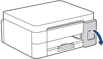
Abra o compartimento do tanque de tinta. (As ilustrações neste guia podem não corresponder exatamente ao seu modelo, mas os passos são os mesmos para todos os modelos.)
