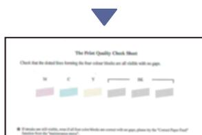
Quando a limpeza inicial do sistema de tinta terminar, o equipamento imprime a folha de verificação de qualidade de impressão.
