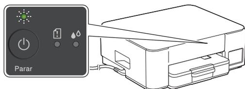
O equipamento é ligado automaticamente e o LED de energia elétrica fica piscando.
