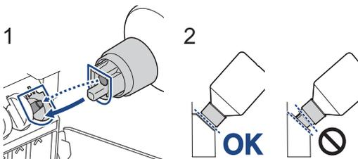
Alinhe o frasco de modo que o pino do tanque de tinta possa ser inserido no orifício do frasco, conforme mostrado em (1).
