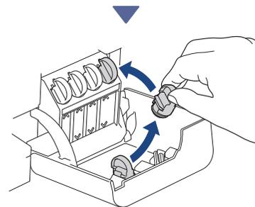
Remova a tampa de dentro do compartimento do tanque de tinta e feche o tanque de tinta.
