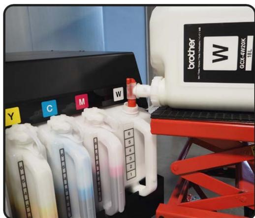
Esta ferramenta irá ajudar a movimentar os recipientes de tinta para bulk até a posição de reabastecimento dos reservatórios de forma limpa e fácil.
