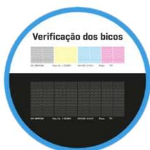
• Se for detectado um bico inoperante: Realize as **Limpezas das Cabeças**, execute impressões de **Verificação dos Bicos** e verifique o resultado novamente. Continue o mesmo processo até que os bicos obstruídos estejam todos **DESOBSTRUÍDOS** novamente.
